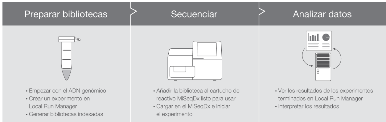
Figura 2: Proceso de ensayo de MiSeqDx en tres pasos. El instrumento MiSeqDx forma parte de un proceso integrado de tres pasos. Solo hay informes con resultados detallados en los ensayos específicos según el objetivo como, por ejemplo, el Extended RAS Panel, el ensayo de 139 variantes de la fibrosis quística MiSeqDx y el ensayo de secuenciación clínica de la fibrosis quística MiSeqDx.
