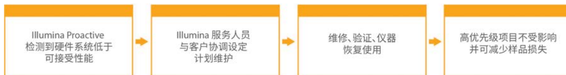
图 1: 举例说明 Illumina Proactive 如何通过故障风险检测以及简化故障诊断让实验室受益 — 系统性能数据的例行监控实现对光学硬件故障风险的检测，据此产生围绕高优先级项目的计划维护。避免造成潜在的时间、人工和样品的巨大损失。
