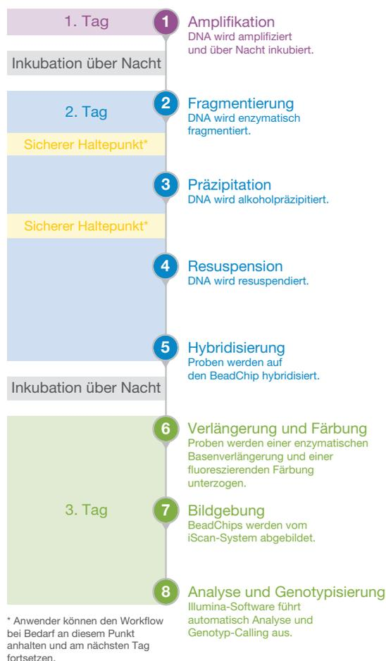
**Abbildung 2: Infinium-HTS-Workflow:** Das Infinium-HTS-Format ermöglicht einen schnellen Workflow von nur drei Tagen mit minimalem manuellem Aufwand.
