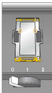
Abbildung 14 Überprüfen der Vakuumöffnungen
