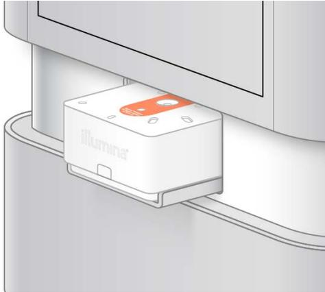
4. Wählen Sie **Close** (Schließen), um die Kartusche einzuziehen und die Blende zu schließen. Die NextSeq 1000/2000 Control Software zeigt nach ca. 3 Minuten Informationen zu den gescannten Verbrauchsmaterialien an.
