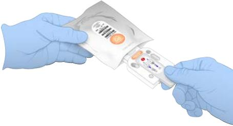
3. Sujete la celda de flujo por la pestaña gris con la etiqueta de la pestaña orientada hacia arriba.
