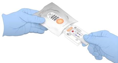
3. Segure a célula de fluxo pela patilha cinzenta com a etiqueta na patilha voltada para cima.
