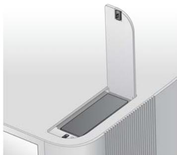
3. Pressione para libertar o cartucho do filtro de ar, remova-o do centro do painel e elimine-o.
