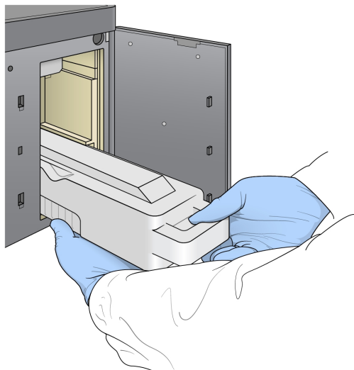
Рисунок 13. Извлечение контейнера с использованными реактивами
