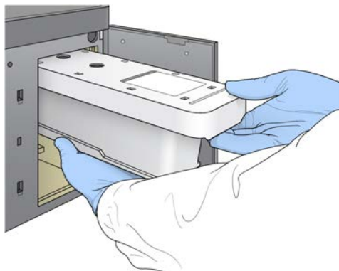
Рисунок 16 Загрузка картриджа с буфером
