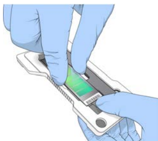
Рисунок 21 Установка и закрепление чипа BeadChip
