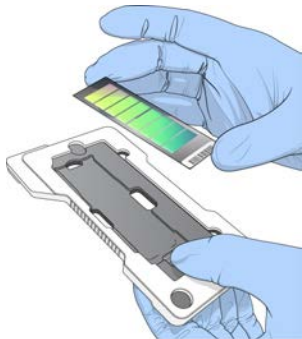
Рисунок 20 Загрузка чипа BeadChip в адаптер
