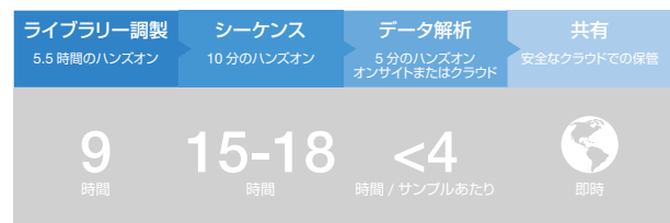
図 2: NextSeq 550 システムのシーケンスワークフロー NextSeq 550 システムは、サンプル調製からデータ解析まで、簡単に統合されたワークフローを提供します。ワークフロー時間は実験およびアッセイタイプによって異なります。こちらに記載している時間は mRNA 発現プロファイリング実験で 75 bp × 2 を想定しています。解析結果は発現差および選択的転写物の同定を含みます。
