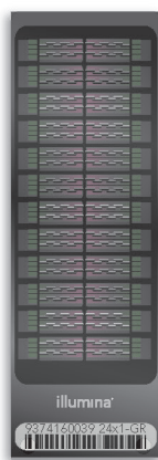
Figura 1: Infinium CoreExome-24 v1.4 BeadChip: Infinium CoreExome-24 v1.4 BeadChip a 24 campioni consente la genotipizzazione di tag SNP informative e marker mirati all'esoma su diverse popolazioni mondiali, fornendo dati di elevata qualità che possono essere utilizzati per diverse applicazioni a valle.
