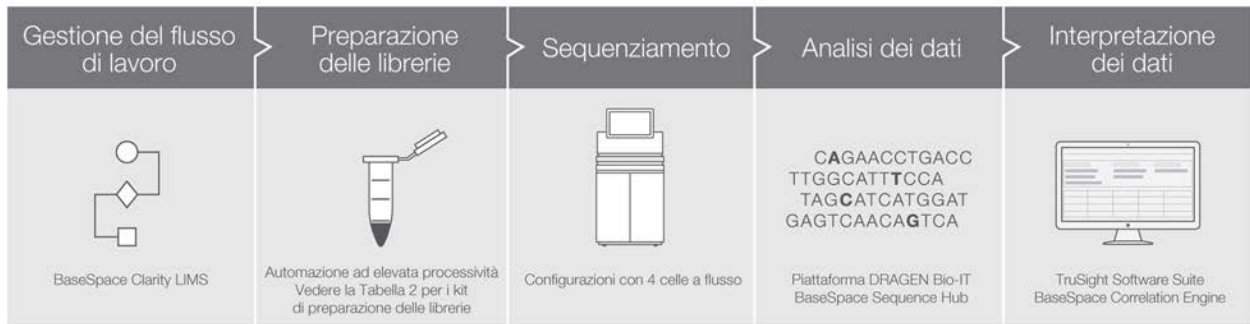
Figura 4: Il sistema NovaSeq 6000 fa parte di un flusso di lavoro di sequenziamento completo: il sistema NovaSeq 6000 è compatibile con BaseSpace Clarity LIMS, il portafoglio di kit di preparazione delle librerie Illumina, il supporto per i "metodi qualificati" Illumina, le soluzioni di analisi dei dati come la piattaforma DRAGEN Bio-IT e BaseSpace Sequence Hub e gli strumenti di interpretazione dei dati a valle come TruSight Software Suite e BaseSpace Correlation Engine.
