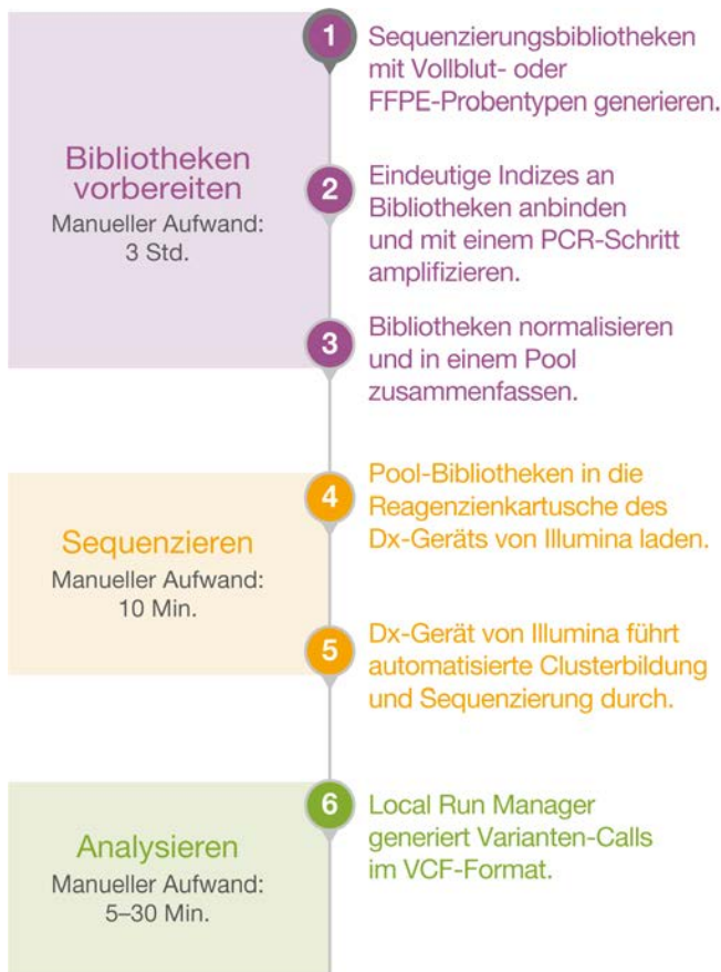
Abbildung 2: Optimierter Workflow für anwendungsspezifische Assays: Der TruSeq Custom Amplicon Kit Dx-Workflow liefert in einem optimierten sechsstufigen Prozess DNA-zu-Daten-Ergebnisse.
