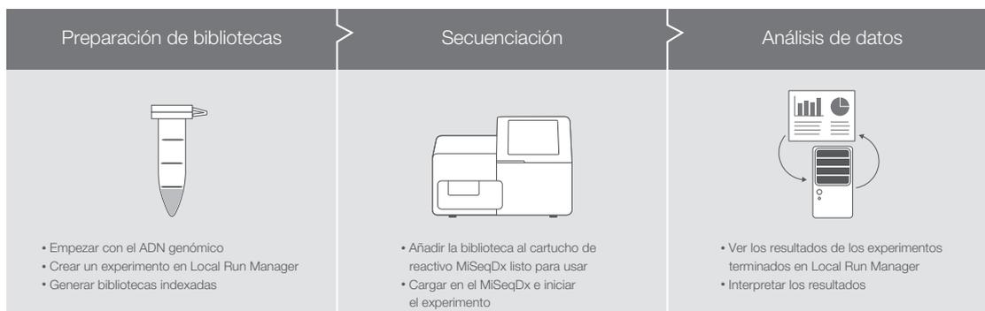
Figura 2: procesos para ensayos de MiSeqDx en tres pasos. El instrumento MiSeqDx forma parte de un proceso integrado que incluye la preparación de bibliotecas y el análisis de datos para ensayos diagnósticos moleculares. Solo hay informes con resultados detallados en los ensayos específicos según el objetivo como, por ejemplo, el Extended RAS Panel, el ensayo de 139 variantes de la fibrosis quística TruSight y el ensayo de secuenciación clínica de la fibrosis quística TruSight.
