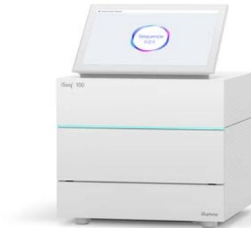
**Figura 1: O Sistema iSeq 100**—Medindo um pouco mais de 0,02 metro cúbico, o Sistema iSeq 100 oferece a potência do NGS no sistema de sequenciamento de bancada mais compacto do portfólio da Illumina.
