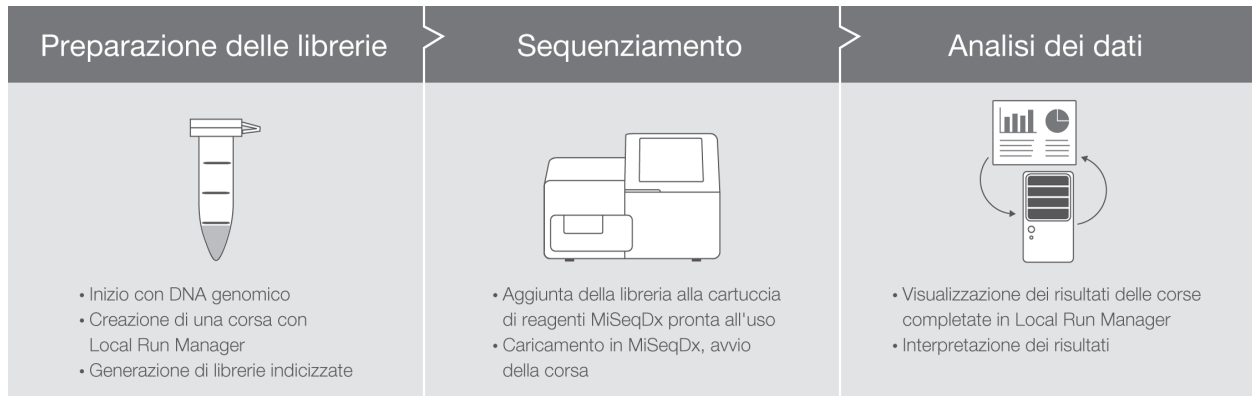
Figura 2: Procedura in tre fasi del saggio MiSeqDx: lo strumento MiSeqDx fa parte di una procedura integrata in tre fasi. I report dettagliati sui risultati sono disponibili solo per i saggi specifici per i target, come pannello Extended RAS, saggio MiSeqDx Cystic Fibrosis 139-Variant e saggio MiSeqDx Cystic Fibrosis Clinical Sequencing.
