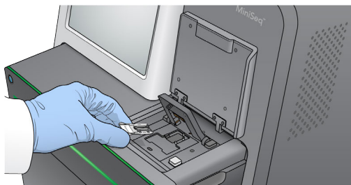
图 18 将流动槽放入流动槽台
