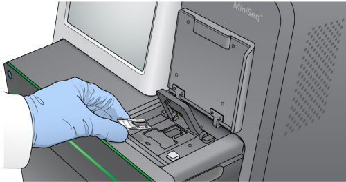
图 12 将流动槽放入流动槽台
