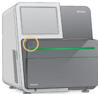
圖 8 電源按鈕位於儀器正面
