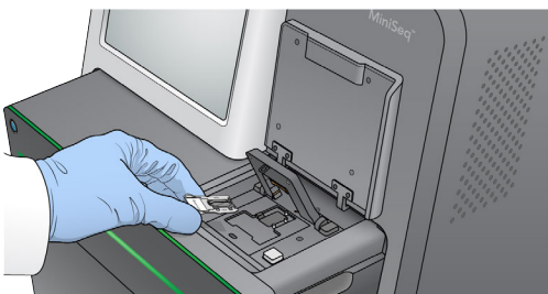
Figure 12 Installation de la Flow Cell sur la platine
