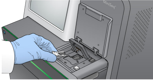
Figure 18 Installation de la Flow Cell sur la platine
