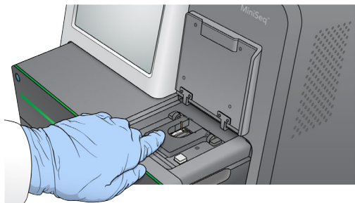
Рисунок 19. Закрывание защелки проточной кюветы
