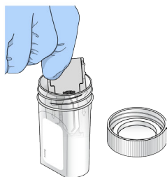
Рисунок 9. Извлечение проточной кюветы
