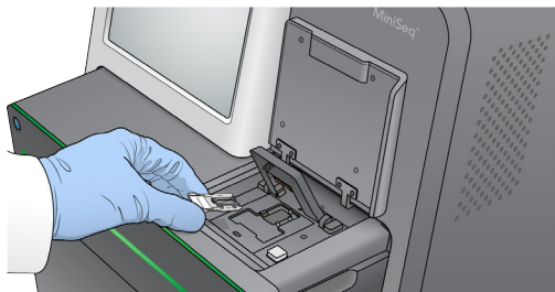
Рисунок 12. Установка проточной кюветы на столик
