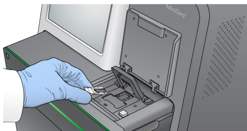
Рисунок 18. Установка проточной кюветы на столик
