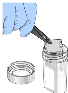
図9 フローセルの取り出し
