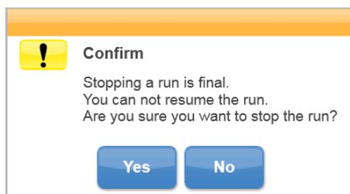
**A interrupção de uma execução é definitiva.** Uma execução interrompida não pode ser retomada. A única opção é seguir para uma limpeza no instrumento.
