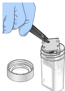
Figura 32 Rimozione della cella a flusso
