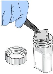
Figura 6 Rimozione della cella a flusso
