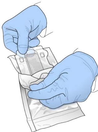
Figura 6 Extracción del embalaje metálico
