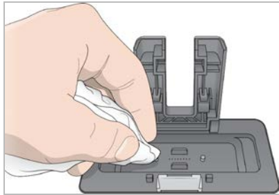
Figura 11 Secado del depósito de lavado
