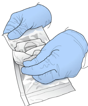
그림 5 플로우 셀 포장 열기
