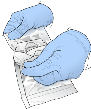
그림 8 플로우 셀 포장 열기
