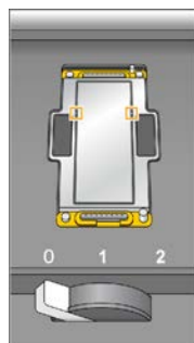
Figura 14 Ispezione dei fori della pompa a vuoto
