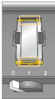
Abbildung 23 Entfernen der gebrauchten Manifold-Dichtungen
