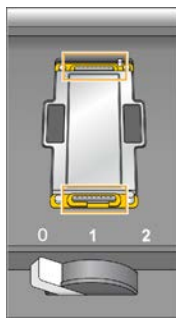
Abbildung 22 Entfernen der gebrauchten Manifold-Dichtungen
