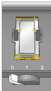
Abbildung 14 Überprüfen der Vakuumöffnungen
