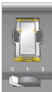
Abbildung 19 Überprüfen der Vakuumöffnungen
