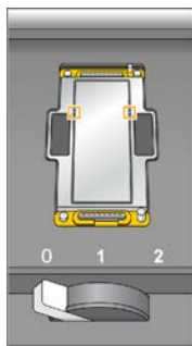
Figura 8 Inspección de los orificios de vacío
