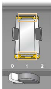
Figura 23 Retirada de las juntas usadas de los distribuidores
