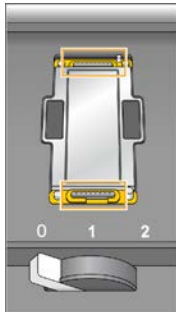
Figura 22 Rimozione delle guarnizioni dei collettori usate
