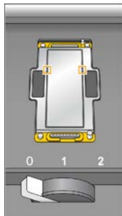
Figura 19 Ispezione dei fori della pompa a vuoto
