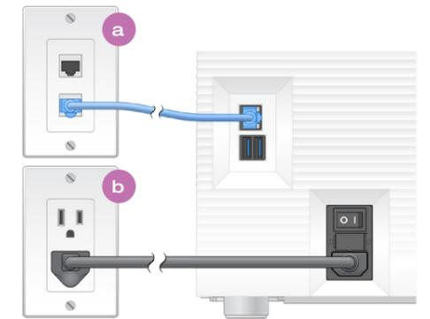
**a** Pour configurer le système iSeq 100 en vue de la connexion à un réseau câblé, branchez le câble Ethernet à un port Ethernet.
