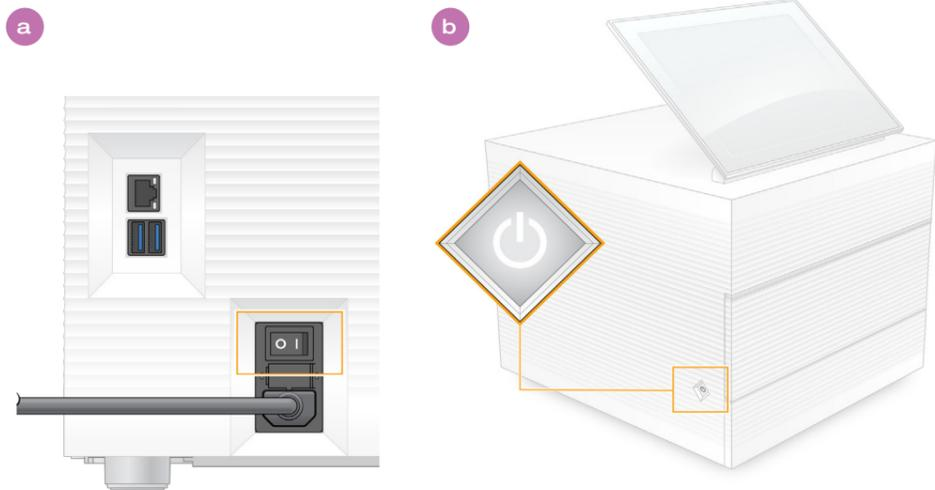
**a** Appuyez sur l'interrupteur situé à l'arrière de l'instrument pour le mettre en marche (position I).
