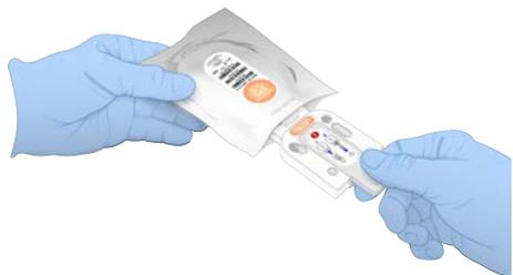
3. 捏住流动槽上的灰色拉条，拉条上的标签朝上。
