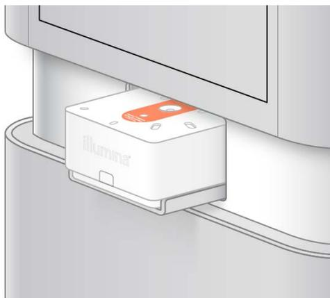
4. 选择 **Close（关闭）** 以缩回夹盒并关闭挡板。
