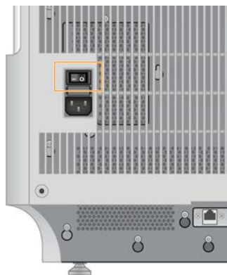
Figura 8 Ubicación del interruptor
