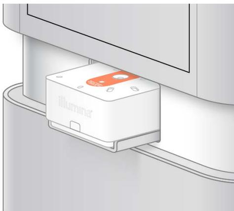
4. Sélectionnez **Close** (Fermer) pour que la cartouche se positionne à l'intérieur de l'instrument et que la visière se ferme.
