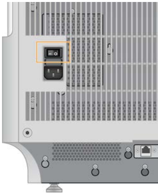
Figura 8 Posizione del pulsante di accensione/spegnimento
