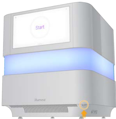
Figura 9 Posizione del pulsante di accensione
