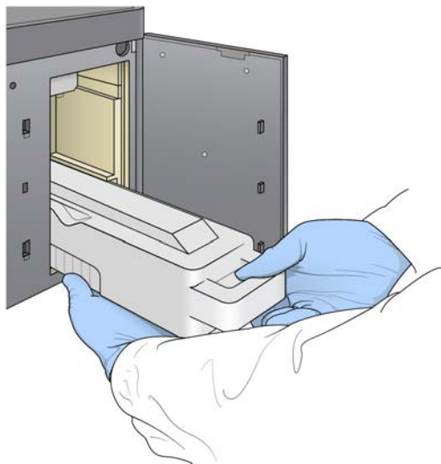
Figura 13 Remover o receptáculo de reagentes gastos
