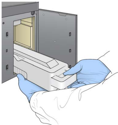
Figura 14 Extracción del contenedor de reactivos usados
