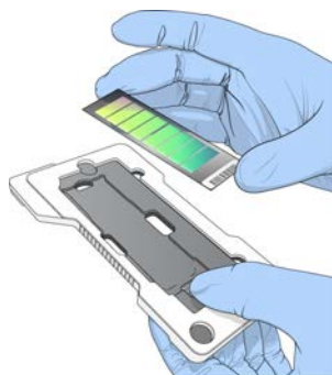
Obrázek 20 Vložení BeadChipu do adaptéru
