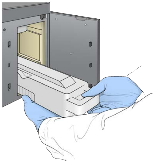
Obrázek 14 Vyjmutí zásobníku na spotřebované reagentie
