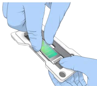
Obrázek 21 Usazení a zabezpečení BeadChipu
