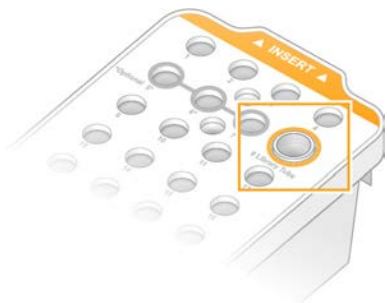
Figura 20 Provetta delle librerie senza tappo caricata nella posizione n. 8
