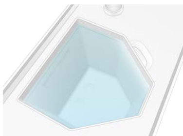
Figura 29 Pozzetto centrale riempito fino alla linea di MIN FILL VOLUME (Volume di riempimento minimo)
