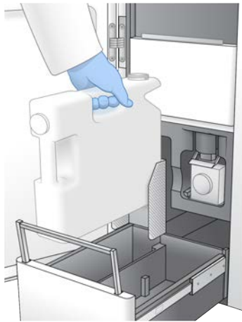
Figura 13 Riposizionamento del flacone vuoto nel suo alloggiamento
