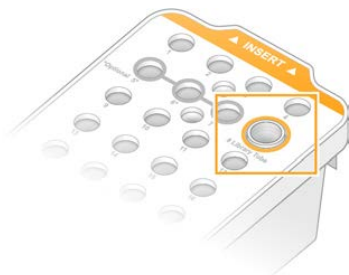
図14 蓋が外され、位置番号8にロードされたライブラリーチューブ
